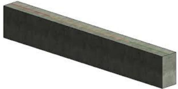
A viga de seção retangular é composta principalmente por concreto armado ou aço. O concreto armado consiste em uma combinação de concreto e barras de aço, onde o concreto fornece resistência à compressão e o aço fornece resistência à tração. Essa combinação de materiais permite que a viga suporte e distribua as cargas de maneira eficiente.
